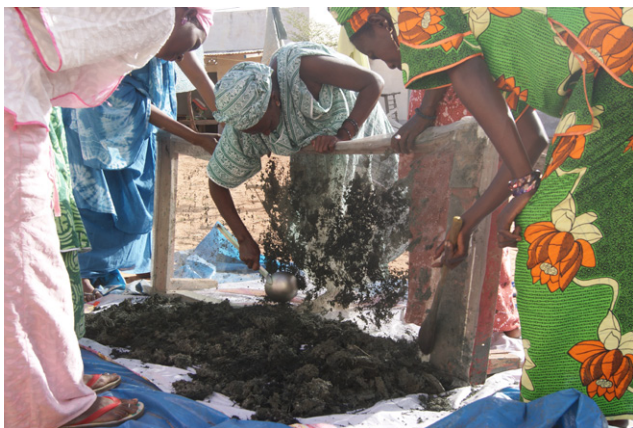
Après séchage sur le châssis/tamis, le pigment est décollé, puis réinstallé sur le châssis.
