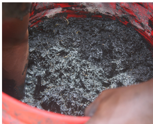
Cuve pigment noire. A partir de ce mélange peu liquide on fabrique le pigment qui présente l'avantage d'une utilisation très simple en dispersion dans l'eau.
