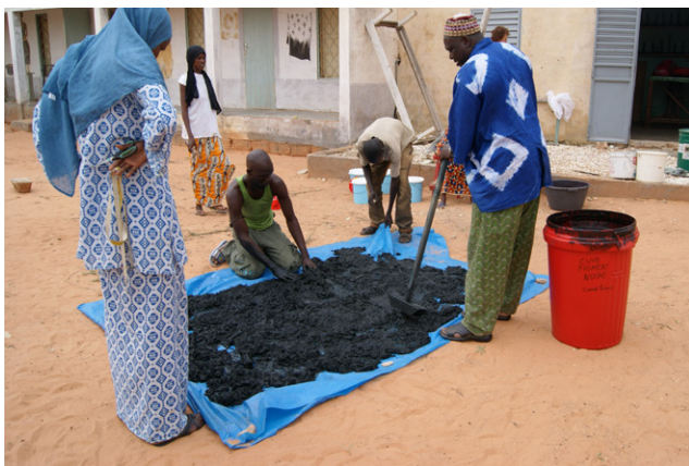
Le pigment est étalé sur un plastique pour le séchage pour ne pas perdre de liquide
